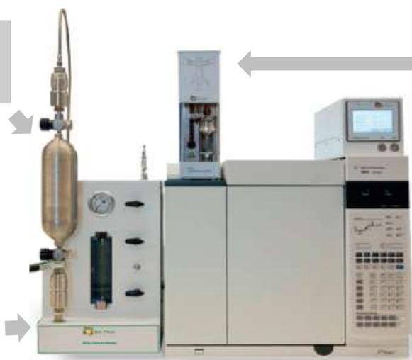
El inyector de Gas Licuado permite La inyección directa y segura de Gas Licuado en la columna del GC
