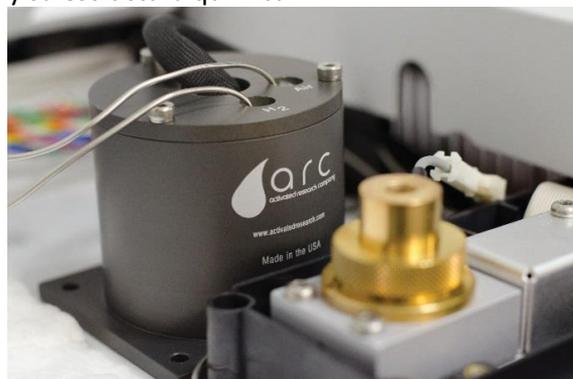
Figura 1. Sistema Polyarc instalado en la posición del detector trasero junto a un FID en un GC Agilent 7890.
