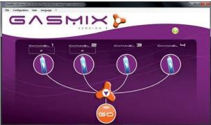
El software diseñado a medida monitoriza y controla continuamente los controladores de flujo másico (MFC) y permite la generación automática de mezclas de gases en una secuencia programada. Cierres de contacto seco o contactos digitales aseguran que el software puede ser controlado de forma remota, enviar una señal con el fin de dirigir una válvula externa o iniciar un analizador.
