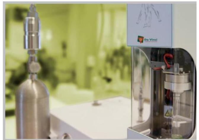
El recipiente de muestra va instalado en la parte frontal de la estación de presurización y es presurizado a 25 bares. La muestra deseada es venteadada a un recipiente de residuos. El controlador situado en la parte superior del GC dirige el ciclo de inyección.
