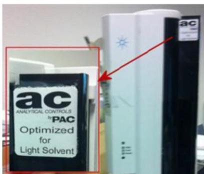
Figura 2: 7693A ALS Optimizado por AC para disolventes ligeros
