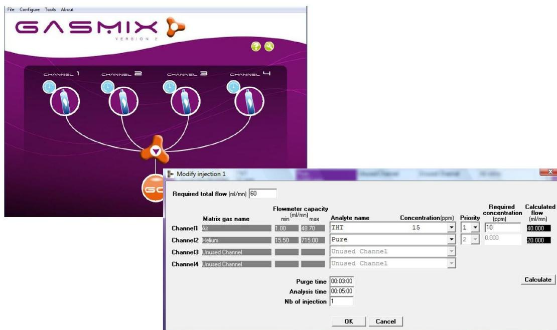
Uno de los cilindros es un patrón con 15 ppm mol / mol THT, en el otro hay helio. Estos dos gases se mezclan y se inyectan en el loop de muestra del analizador.
