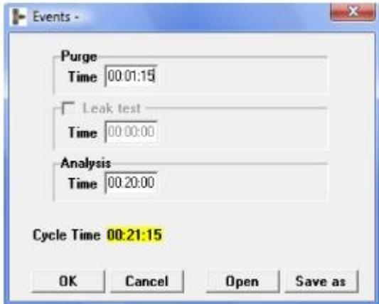
La purga del loop de muestra está configurada para 1 minuto y 15 segundos. Durante ese tiempo, los MFC abren sus válvulas a los flujos deseados.
