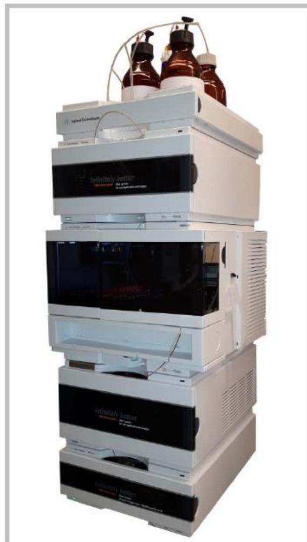
Figura 3: Apilamiento completo incluyendo el horno de reacción
