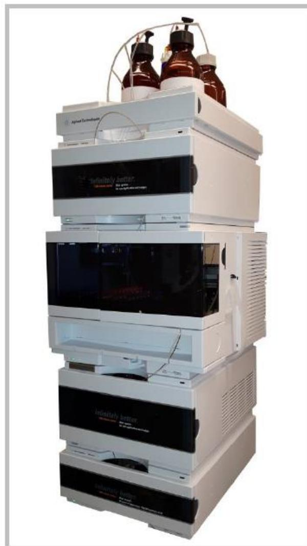
Figura 1: El sistema LC incluye el Horno de Reacción desarrollado por DVLS
